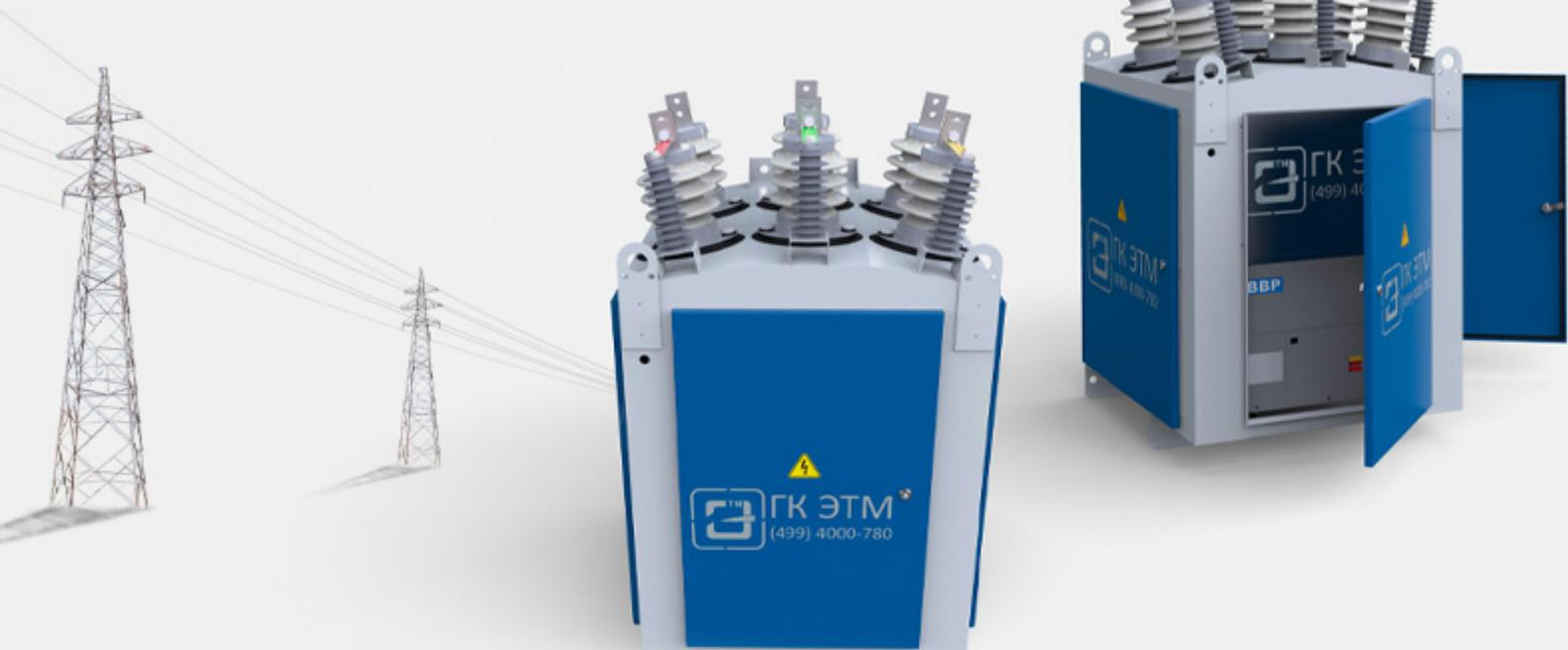
**Пункт Секционирования Столбовой ПСС-6(10)** – это коммутационный аппарат наружной установки, предназначенный для оперативного включения/отключения воздушных линий и отделения повреждённых участков ВЛ от энергосистемы в случае возникновения аварийных режимов работы. Высокая степень автоматизации ПСС позволяет в кратчайшие сроки локализовать аварию, что, в свою очередь, ощутимо снижает издержки, вызванные недоотпуском электроэнергии потребителям.
